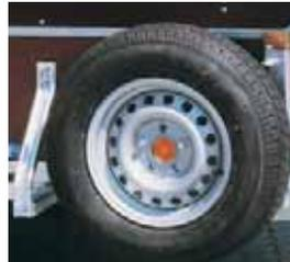
**Ersatzrad mit Halterung**, an der Bordwand montiert.
