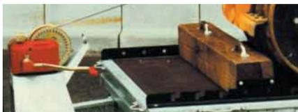
**Ladungssicherung speziell für Walzen** durch zwei in der Länge verstellbare Querbalken. Diese werden in Arretierschienen rechts und links an der Seitenwand verzapft.
