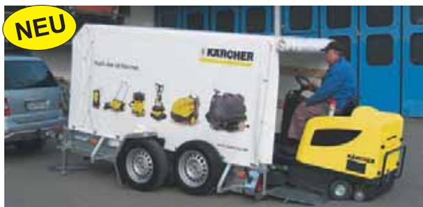
**ASB 1800K – Absenk-Anhänger mit Ladungssicherung TopZurr® 22.** Der gesamte Aufbau lässt sich mittels elektrohydraulischer Einrichtung mit Hydraulikzylindern absenken. Die hintere Klappe ist dank speziellem Auffahrprofil leicht überfahrbar und der Auffahrwinkel ist so flach, dass auch kleinrädige Fahrzeuge problemlos auffahren können. Durch Ausstattung mit TopZurr® 22 sind Fahrzeuge wie Hubwagen, Ameise oder Wasch und Kehrgeräte nicht nur schnell, sondern auch sicher verladen.
