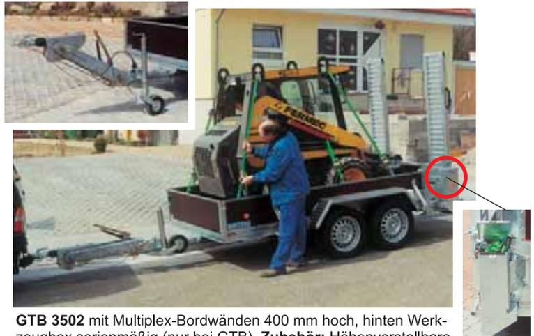
**GTB 3502** mit Multiplex-Bordwänden 400 mm hoch, hinten Werkzeugbox serienmäßig (nur bei GTB). **Zubehör:** Höhenverstellbare Auflaufbremse mit LKW-DIN-Zugöse, verstellbar von 400 bis 1100 mm Anhänghöhe (auf Wunsch mit Kugelkupplung wechselbar).
