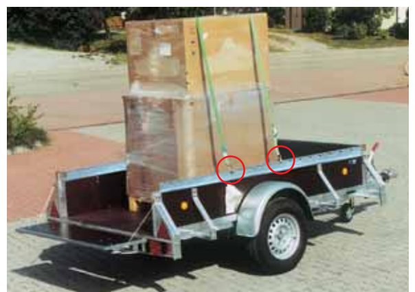
PK 1351 mit serienmäßiger Gurtleiste. Auch hohe Ladung kann hier sicher verzurrt werden. Hintere Klappe mit Seil gerade zu stellen serienmäßig. Die Klappe kann für die Verladung mit Stapler auch ganz abgenommen werden.
