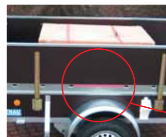
Aufsätze werden auf den ganz normalen Anhänger Typ PK mit Gurtleiste aufgesetzt. Die Gurtleiste kann für die Ladungssicherung auch in diesem Falle verwendet werden . Der Zurring wird durch die Öffnungen gezogen.
