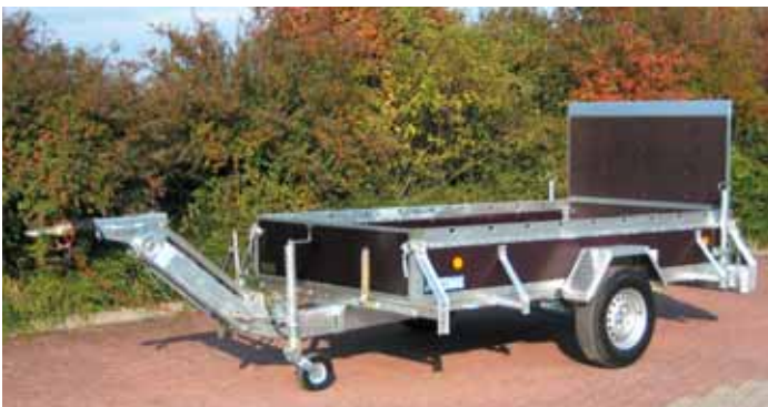
Typ PK mit höhenverstellbarer Auflaufbremse mit DIN-Zugöse für LKW. Verstellbar von 400 mm bis 1100 mm Anhängöhe. Vordere Klappe nur abnehmbar nicht umklappbar. Zu Kugelkupplung wechselbar gegen Mehrpreis. Ausserdem Zubehör: Alu-Riffelblech-Kotflügel, Laderampe.
