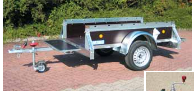
PK 751 mit Zubehör vordere Klappe, ausziehbare Deichsel um 500 mm und Stützrad leicht mit Feststellbremse (Pinstop) inkl. 2 Unterlegkeile. Der Bolzen des Pinstops verhindert das Wegrollen. Einsatzpflicht der Unterlegkeile an Steigungen, der Pinstop ersetzt keine Handbremse. Set inkl. rotem Rangiergriff zum Bewegen des Anhängers.
