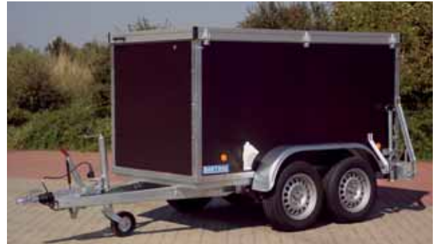
PK 2002 serienmäßig mit Zugholmen, V-Bremse und Stützrad schwer automatisch umklappbar, geschützt innerhalb der Holme montiert. Mit Zubehör Thermodeckel, Rohrstützen, Überhöhe der Bordwände rundum, hinten eine Türe.
