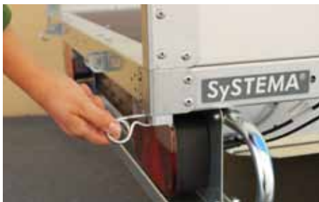
d) Bordwand mit Splint fixieren fix the panel with the cotter pin
