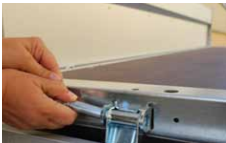
g) Scharnierbolzen einführen insert the hinge bolt
