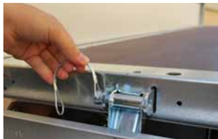
h) Bolzen mit Sicherungsbügel schließen close the bolt with retaining clip
